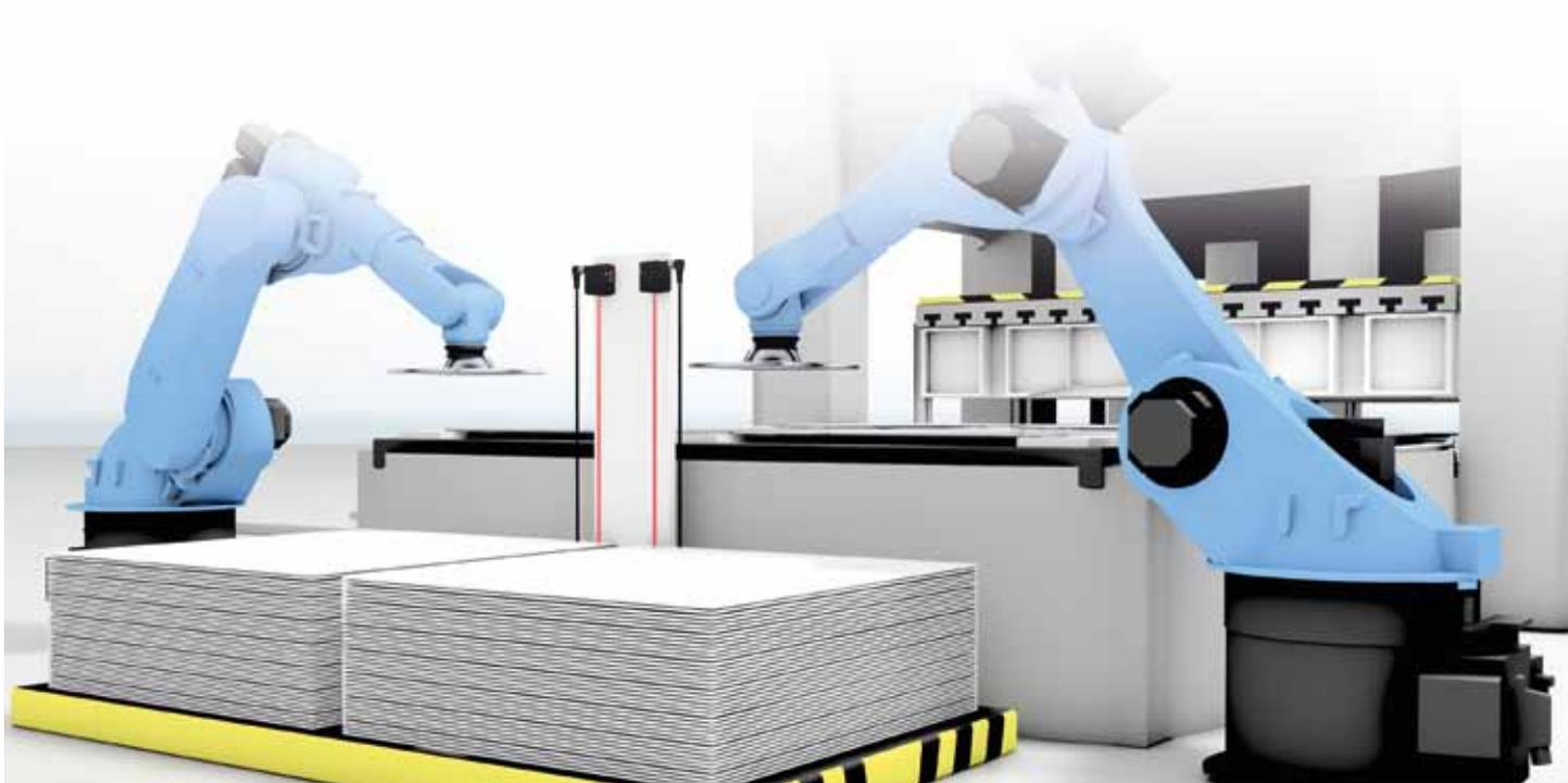
Le capteur BOD 23K permet le positionnement ou la mesure fiable et précis(e) des pièces, indépendamment des propriétés du matériau et de la surface.
