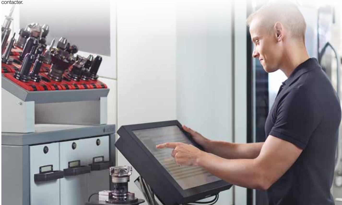
L'identification d'outils basée sur la technologie RFID optimise les temps de préparation.
