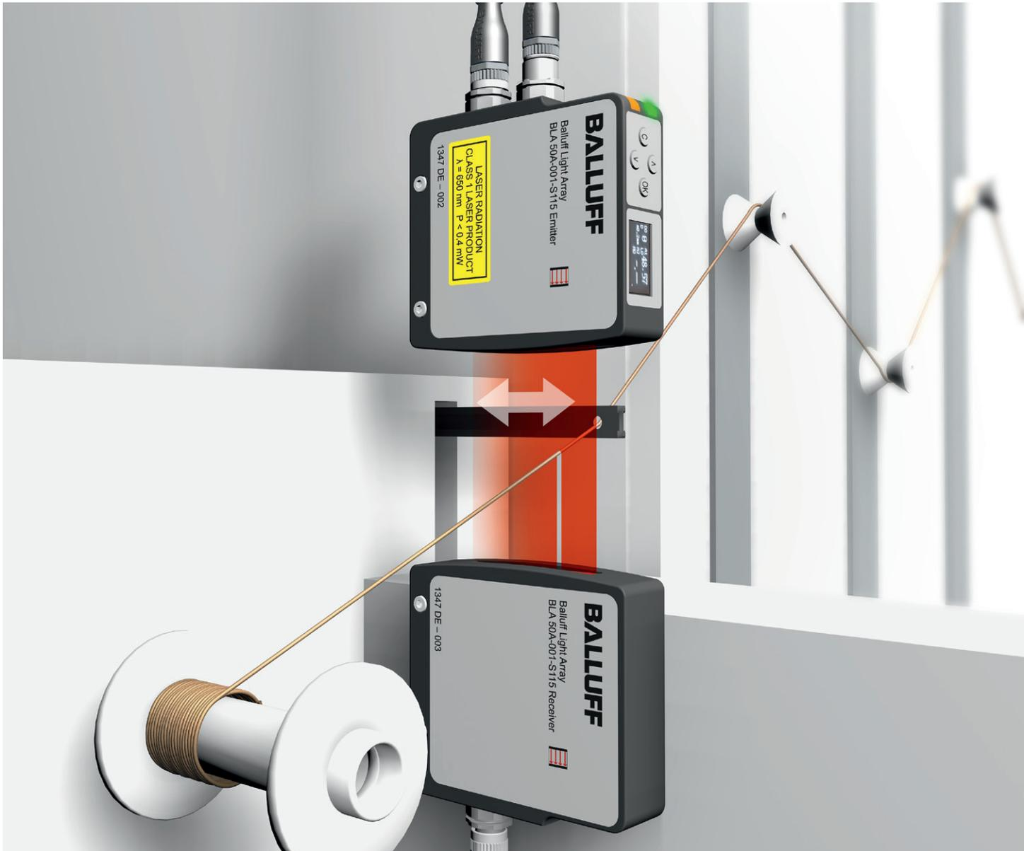
Lorsqu'il s'agit, dans des processus de fabrication et d'emballage ou dans le cadre du contrôle qualité, d'identifier différents objets, la nouvelle bande lumineuse haute résolution BLA est idéale. Elle identifie, compare ou trie les objets en fonction d'une taille minimum ou de différence de hauteur.
