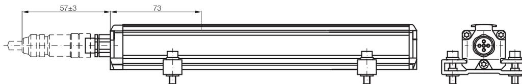
**Connexion enfichable DeviceNet S93 avec connecteurs BKS-S 92-00, BKS-S 93-00 et BKS-S-48-15-CP-\_\_, page 234**
