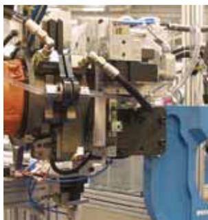
Système hydraulique de rivetage
