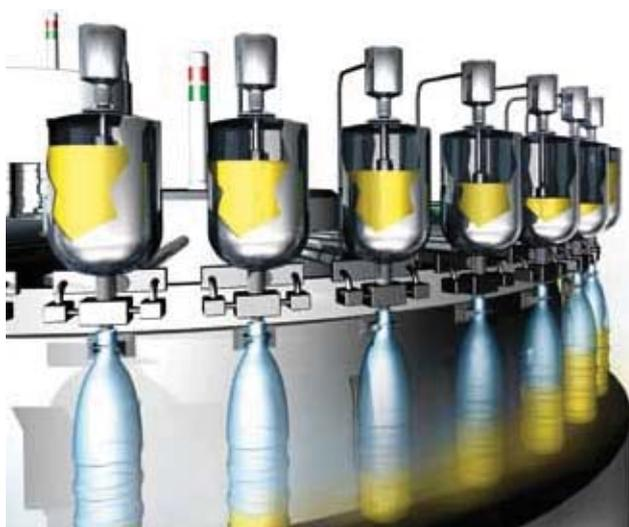
Contrôle du niveau de remplissage
