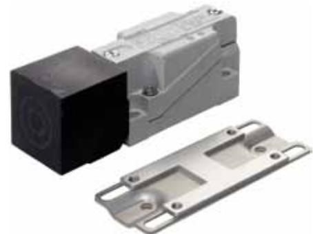
Le BIS C-324 peut être décalé sur cette plaque de montage, à l'état câblé, jusqu'à 30 mm, puis fixé à l'endroit souhaité. Pour ce faire, desserrer simplement les vis de fixation (M5×25, fournies), procéder au décalage et resserrer les vis. La plaque de montage est réalisée en aluminium anticorrosion.
