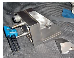
Des fissures se forment sur l'outil en raison d'un défaut dans l'alimentation. L'outil n'est plus utilisable. La production est arrêtée.
