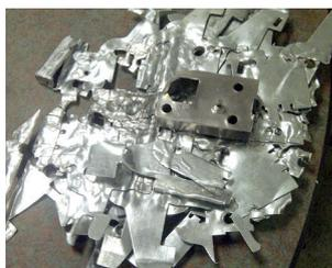
Une pile de tôles a détruit le dévêtisseur, nécessitant une réparation importante de l'outil.
