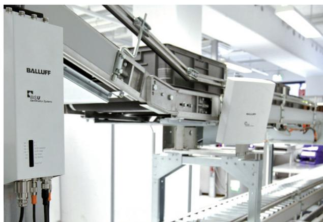
Les supports de données RFID UHF permettent le suivi de l'ensemble des mouvements de marchandises entre les différentes stations – des composants entrants aux produits finis sortants.
