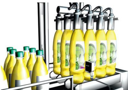
Positionnement correct des bouteilles avant le reconditionnement
