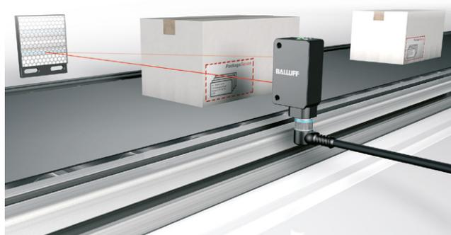
Détection de paquets indépendante de la surface à l'aide d'un barrage optique à réflexion
